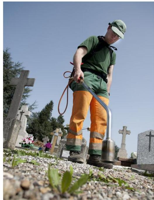
Figure 1 : Système de désherbage thermique
